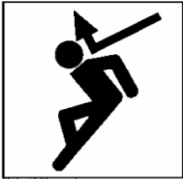
图 A.15 用箭头表示跌落物或飞出物及其运动方向的危险图示示例
