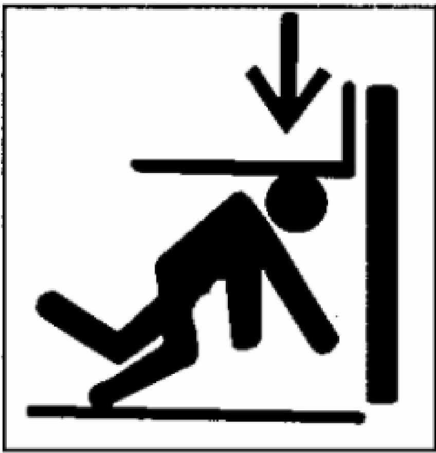
图 A. 17 用箭头表示机器部件运动方向的危险图示示例
