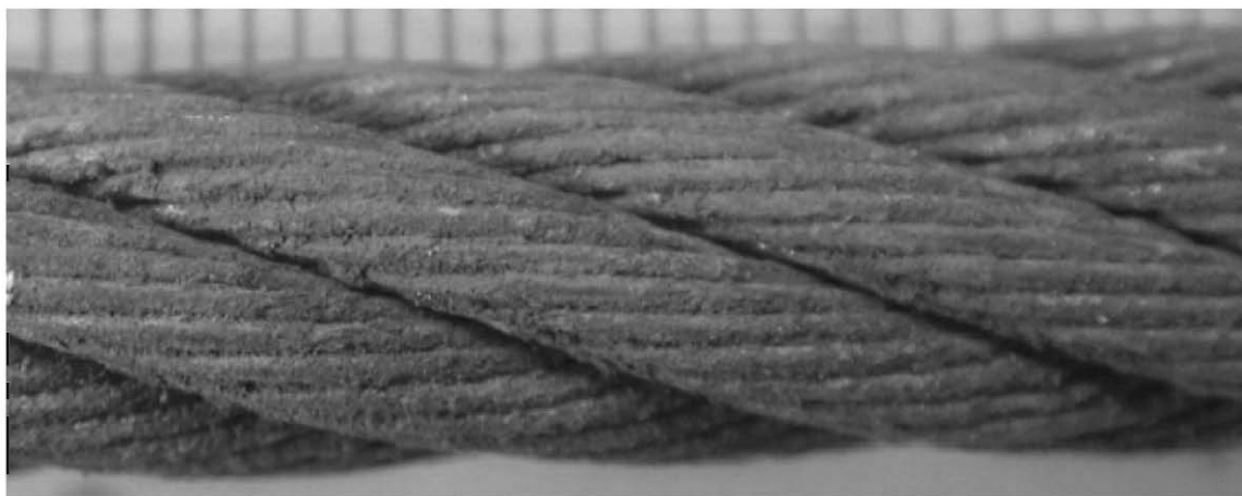
图 I.2 钢丝表面手感粗糙,普通的表面氧化——趋于报废的严重程度级别 20%
