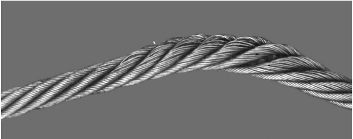
图 B.16 局部扁平(弯曲型)
