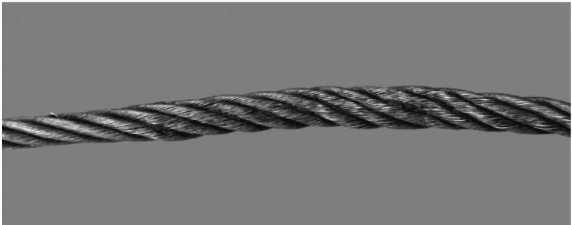
图 B.17 局部扁平(平直型)
