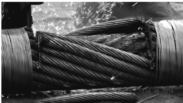
图3 大直径阻旋转钢丝绳更换和切割方法
