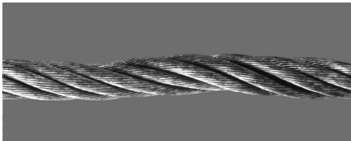
图 B.5 钢丝绳直径局部减小(绳股凹陷)
