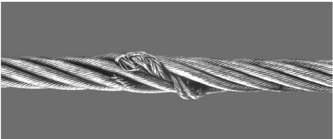
图 B.11 绳芯突出——单层钢丝绳
